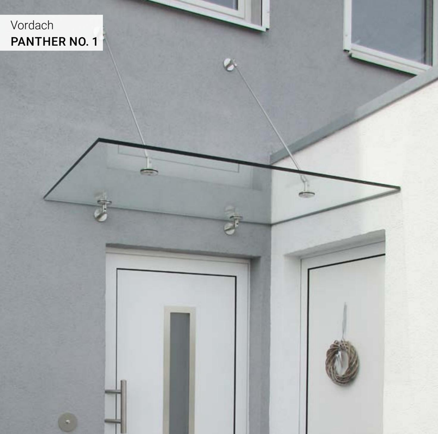
Bei unserem System PANTHER NO. 1 sorgen Zugstreben aus Edelstahl oberhalb des Glases für Stabilität und Sicherheit. Von unten wird das Vordach durch Glas-Wand-Halter gestützt. Dank dieser Befestigungsart bietet das abgehängte Vordach hohe Flexibilität bei der Anbringung. Die Trägeranzahl richtet sich nach der gewählten Glasbreite und -tiefe.
